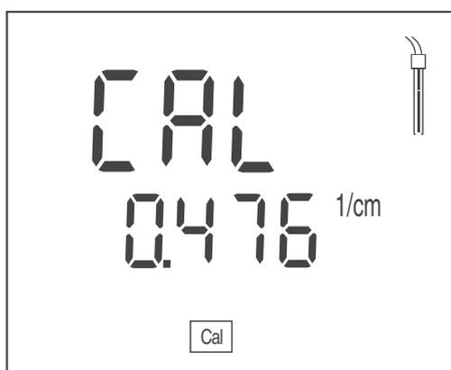
4. Avec **<CAL>**, sélectionner une constante de cellule dans une plage appropriée.
