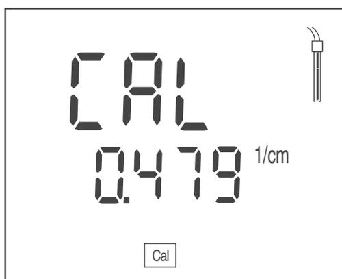
4. Le cas échéant, sélectionner la constante de cellule appropriée avec **<CAL>**.
