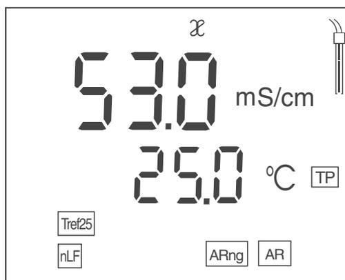
4. En cas de mesure sans sonde de température, entrer la température de la solution de mesure avec <▲><▼>.
