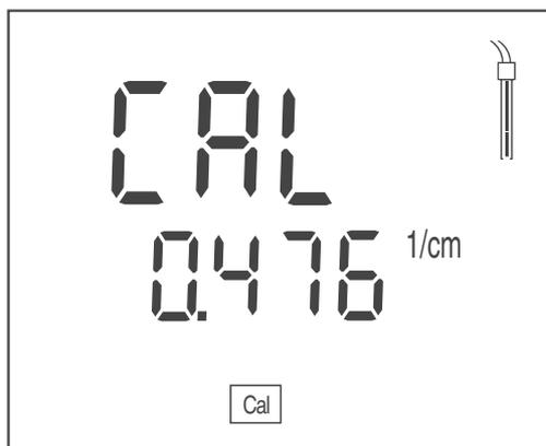
4. Plonger la cellule de mesure dans la solution étalon de contrôle (0,01 mol/l KCl).
